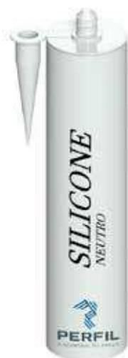
UTILIZAÇÃO: NAS ETAPAS DE MONTAGEM E INSTALAÇÃO DA ESQUADRIA, DEVE SER APLICADO O SILICONE NEUTRO EM TODOS OS CANTOS, ENCONTRO ENTRE PERFIS, APLICAÇÃO DOS COMPONENTES DE FIXAÇÃO E JUNTAS DE DILATAÇÃO.
